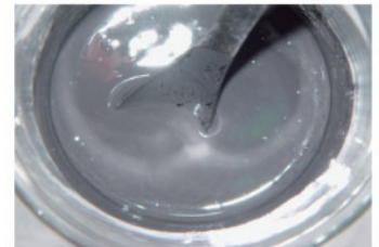
Natural status of MR fluid 液體磁流的自然狀態
