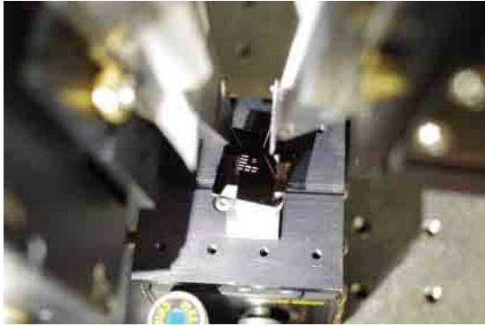
Hybrid Silicon Waveguide Laser on silicon-on-insulator (SOI) chip 在SOI上的混合矽波導激光器
